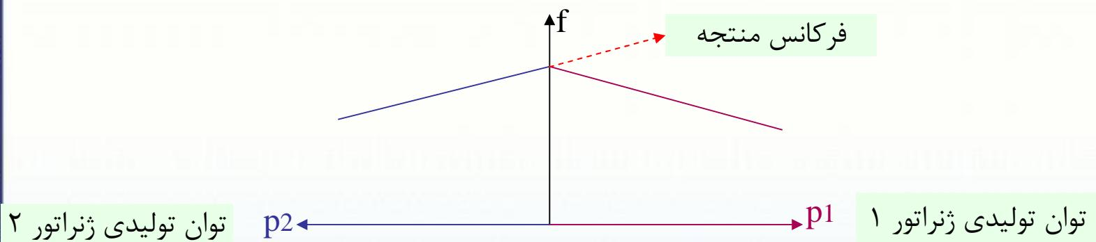
اگر در این حالت باری به این دو ژنراتور وصل شود ، همانگونه که از دیاگرام زیر پیداست فرکانس اندکی افت می کند و ژنراتورهای ۱ و ۲ توانهای را تولید می کنند که جمع آنها با توان مورد نیاز بار برابر است
