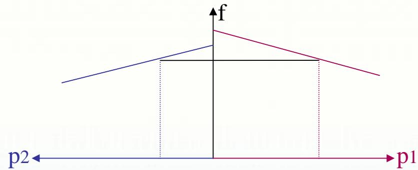
اگر Set point به طور مناسب تنظیم نشوند ممکن است حالتی رخ دهد که یکی از ژنراتورها به شکل یک بار برای دیگری عمل کند
