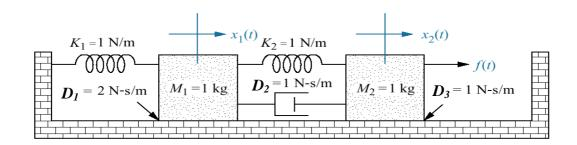
۲- دوگان مداری (موازی) هر یک از سیستمهای مکانیکی نشانداده شده در شکل زیر را رسم کنید:
