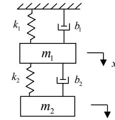
$$\begin{aligned} m_1 \ddot{x}_1 + b_1 \dot{x}_1 + k_1 x_1 + b_2 (\dot{x}_1 - \dot{x}_2) + k_2 (x_1 - x_2) &= 0 \\ m_2 \ddot{x}_2 + b_2 (\dot{x}_2 - \dot{x}_1) + k_2 (x_1 - x_2) &= 0 \end{aligned}$$
